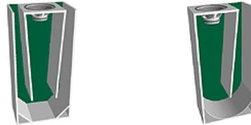
Figura 12: Cajas del tipo Individual Doble B
