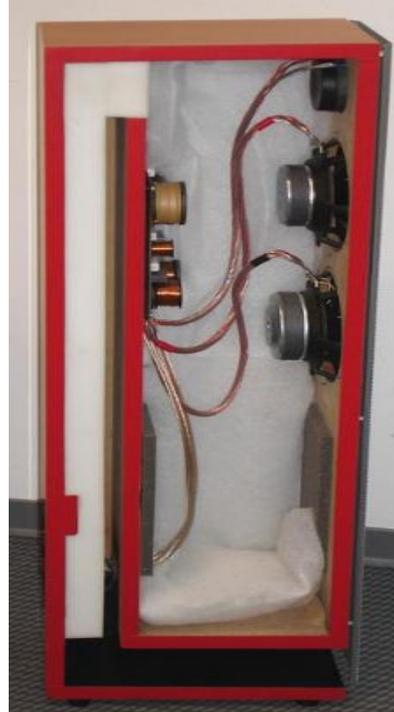
Figura 7: Interior de una caja acústica real tipo LT.
