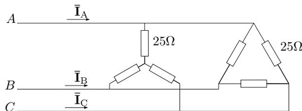
Figura 1: Sistema de cargas en estrella y triángulo.
