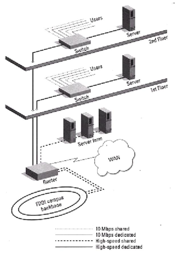
Los servidores en la central de datos son puestos a una sola interface del ruteoador de alta velocidad, compartiendo el ancho de banda. Notar que la funcionalidad de cada servidor en el edificio es optimizada al conectarlo a una interface de alta velocidad, ya sea directa o compartida.
