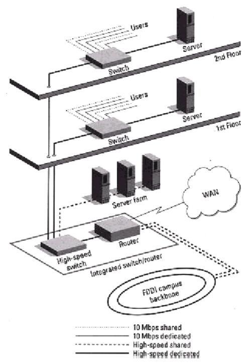
Note que la introducción del switch cambia la tópologia lógica de la red interna y esto impacta en las direcciones del usuario.
