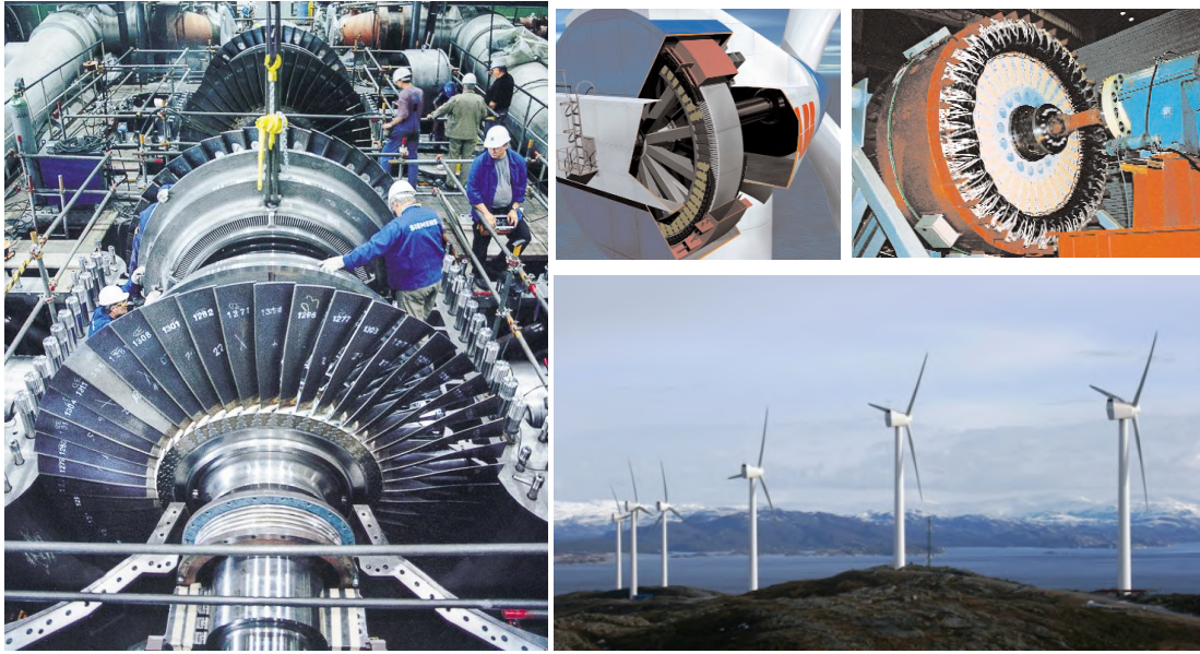
Figura 9.1: Ejemplos de cuerpos rígidos en rotación con eje fijo: turbina de vapor (izquierda); aerogenerador de imanes permanentes que eliminan la necesidad de cajas de engranajes (derecha arriba); parque eólico en las costas de Noruega (derecha abajo).
