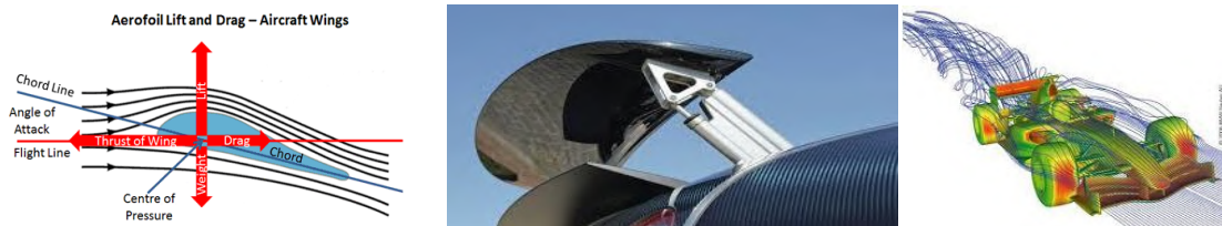
Figura 5.8: Las fuerzas disipativas son inevitables y se deben utilizar racionalmente con diversos propósitos. El ala de un avión tiene una forma tal que al ser propulsada hacia adelante produce una diferencia de presiones entre el flujo superior e inferior de modo que la fuerza resultante sobre el ala tenga una componente de sustentación ( lift ) que supere (para elevarse) o iguale (para mantenerse a altura constante) al peso y una componente de arrastre ( drag ) que tenga mínima oposición al empuje o propulsión de los motores. En alerones traseros de vehículos terrestres (de competición) la dirección de la fuerza de sustentación deseada es hacia abajo, evitando que el vehículo despegue del suelo por efectos aerodinámicos.
