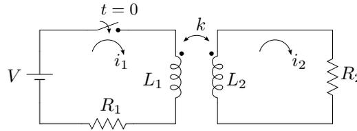
**Figura 34:** Circuito con acoplamiento inductivo.
