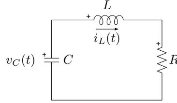
**Figura 39:** Circuito para  $t > 0$  para el cálculo de la respuesta natural.
