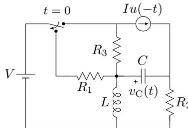
**Figura 33:** Cálculo de la tensión del capacitor  $v_C(t)$  para  $t > 0$ .
