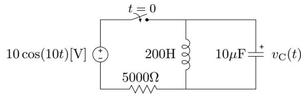
**Figura 28:** Circuito  $RLC$  excitado con señal sinusoidal.
