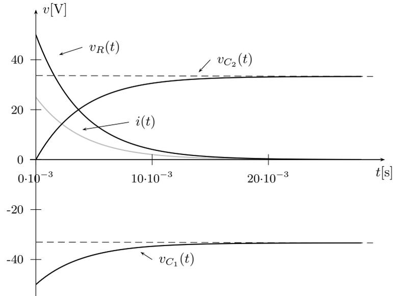
**Figura 37:** Caídas de tensión en cada elemento y corriente total del ejercicio .
