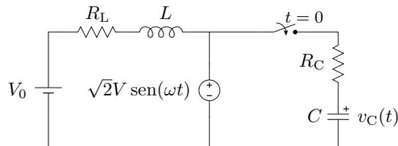
**Figura 21:** Respuesta completa por superposición.
