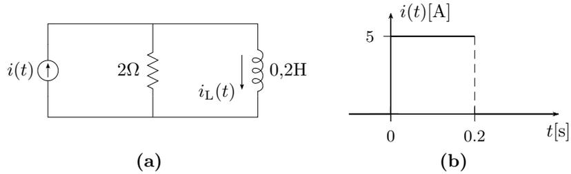
**Figura 10:** Circuito  $RL$  paralelo (a) excitado por la función pulso (b).
