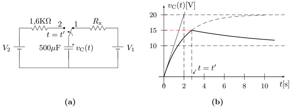
**Figura 4:** Calcular el tiempo  $t = t'$  en el que conmuta el circuito.
