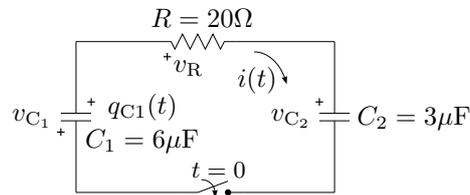
**Figura 12:** Evolución de la tensión natural en un par de capacitores.
