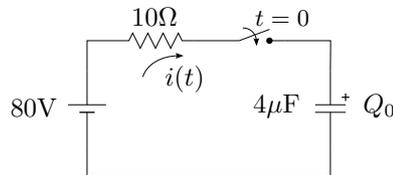
**Figura 6:** Respuesta completa de la tensión en el capacitor.
