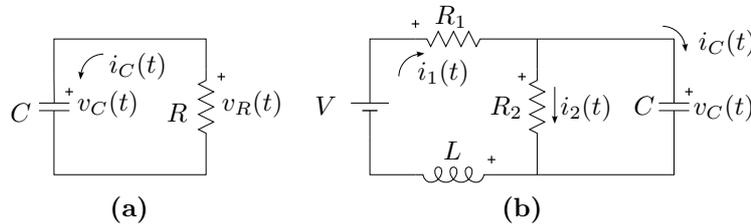
**Figura 35:** Circuitos para el planteo de la respuesta  $v_C(t)$ .
