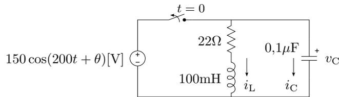
**Figura 25:** Hallar la tensión del capacitor  $v_C$ .
