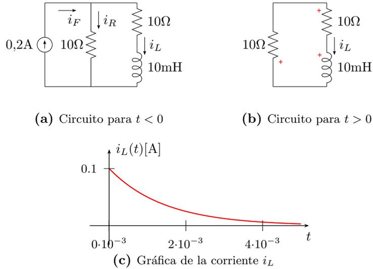
**Figura 36:** Respuesta de un circuito  $RL$  para  $t > 0$ .
