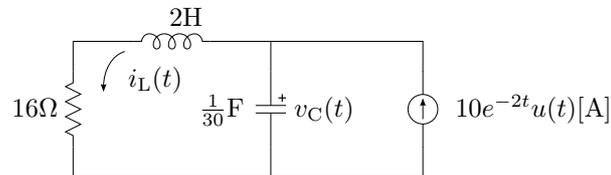
**Figura 26:** Circuito  $RLC$  con fuente de corriente.
