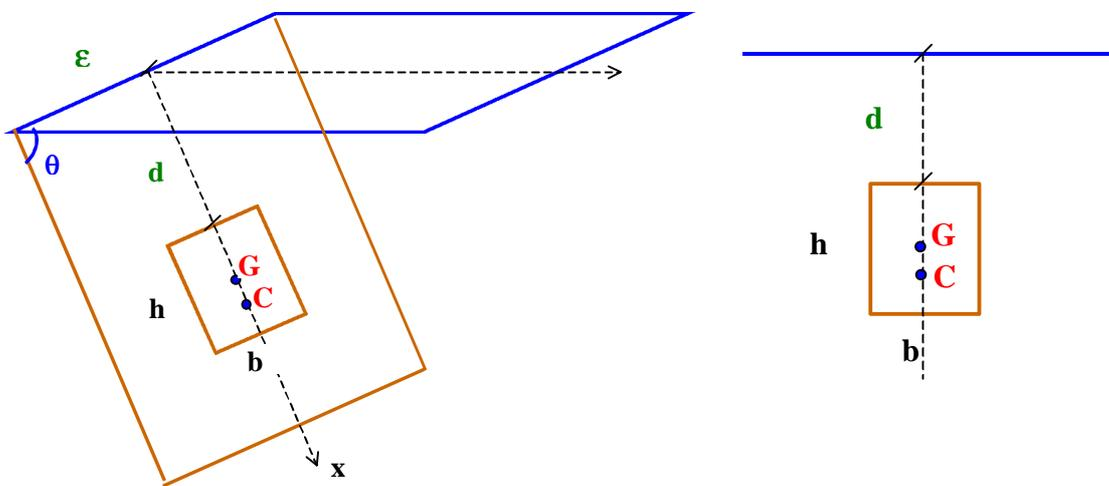
La pared rectangular, de superficie  $\omega = b \cdot h$ , está sumergida a una distancia d de la superficie libre del líquido. Es el caso de una compuerta.
