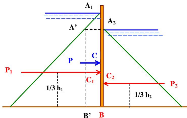
Si  $h_1$  y  $h_2$  son las profundidades respectivas del agua, la presión a cada lado de la pared (caso de paredes rectangulares verticales) será:
