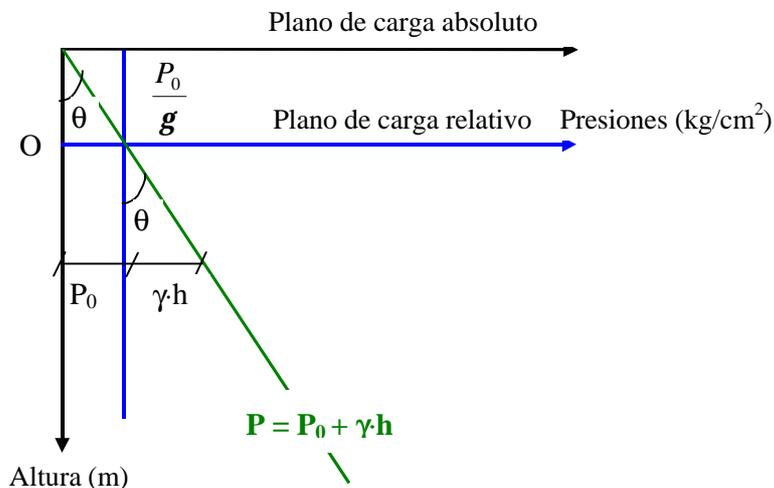
La ecuación  $p = p_0 + \gamma \cdot h$  corresponde a una recta, luego indica la variación lineal de la presión con la profundidad del líquido, cuya representación, tomando como eje horizontal las presiones y como eje vertical las profundidades, proporciona el **diagrama de presiones** (figura).
